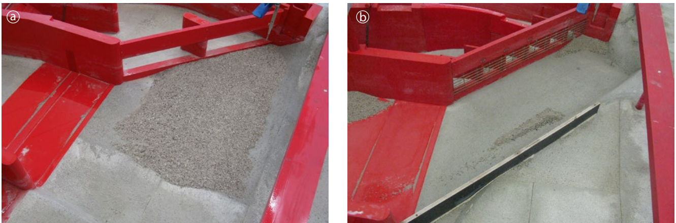
Bild 5: Wasserbaulicher Versuch für die Kiesspülung: a) Ausgangszustand, b) Optimierungsergebnis (Quelle: TU München)
